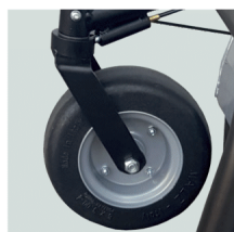
Blocage roue avant lors de la tonte en pente.
